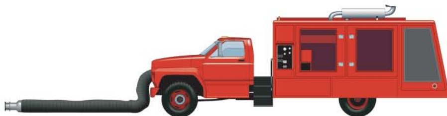
groupe M de climatisation F ground air conditioner aire M acondicionado de tierra F Klimagerät N condizionatore M semovente
